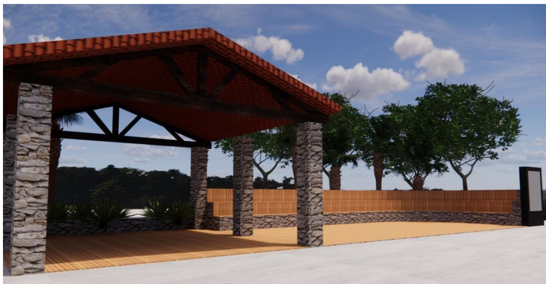
Imagem 4: Imagem Ilustrativa do Deck Acompanhando a área coberta. Como principais soluções destaca-se a continuidade da base em pedra no mesmo estilo das demais do conjunto e o uso de madeira cumaru para revestimento dos bancos e Piso.
